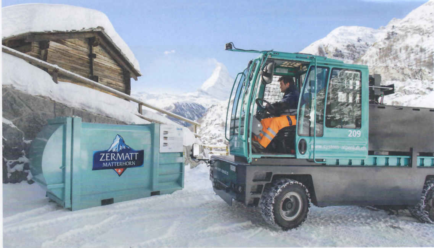
Der Abtransport des Abfalls bis zur kommunalen Sammelstelle erfolgt mit elektrisch angetriebenen Fahrzeugen. Diese sind als Seitenstapler konzipiert worden.
